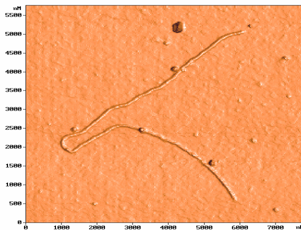
Рис.13. Изображение углеродной нанотрубки в атомно-силовом микроскопе Р-47.
